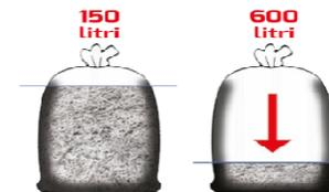
Compattatore Automatico Integrato: riduce il volume dei frammenti distrutti di 4 volte aumentando la capacità del sacco ed evitando frequenti svuotamenti.
